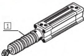
Защитный гофр является полностью герметичным. Для предотвращения попадания пыли и химически агрессивных сред в защитный гофр соединение его внутренней полости с атмосферой должно осуществляться через специальное (вентиляционное) отверстие **1**.
